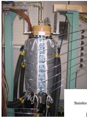
図1 コアホルダー付きメタンハイドレート分解実験装置 海底のMH堆積物を模擬したコア試料を実験室で再現し、インヒビタ（分解促進剤）圧入法による分解実験を実施。海底地層中の状態を模擬するコアホルダー機能を持ち、かつ縦方向に個別温調が可能。
